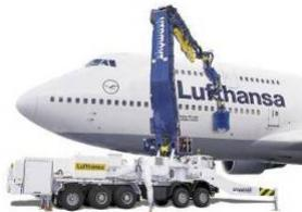
1988: Putzmeister entwickelt aufbauend auf dem FH 26 den **Skywash** – den größten mobilen Flugzeugwaschroboter der Welt. In Zusammenarbeit mit AEG, MOOG, IPA und anderen baut Putzmeister ein stationäres hochflexibles Handhabungssystem mit großer Reichweite (**Large Manipulator, LAMA**). Diese Erfahrungen und die Weiterentwicklung in der Steuerungstechnik führen zu einer revolutionär neuen Art der Verteilermast-Steuerung – der **Ergonic® Boom Control**
