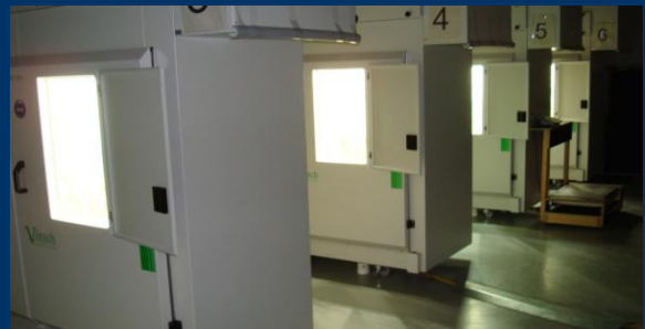
Abb. 2. Voll programmierbare Klimakammern zur Simulation der zukünftigen Temperaturen und CO 2 -Konzentrationen.
