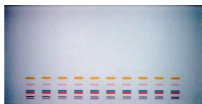
▲ Ausleuchtungskorrektur für Weisslicht: Beispiel ohne Korrektur – mit Standardkorrektur – mit individueller Korrektur (Option 027.6372)
