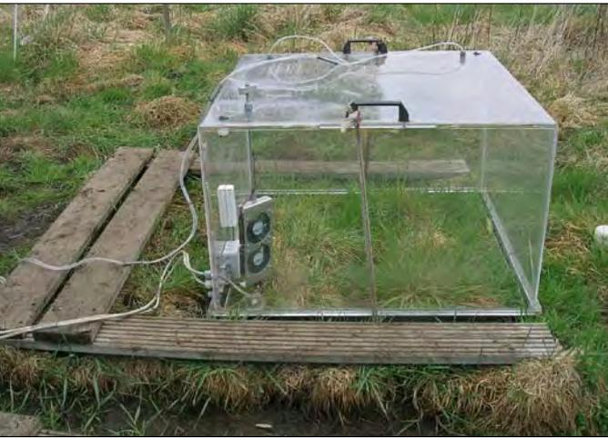
Aus diesen Hauben werden im Untersuchungsgebiet am Oberrhein und im Pfrunger-Burgweiler Ried Gasproben entnommen. Sie können bei höherer Vegetation bis zwei Meter hoch aufgestellt werden.
