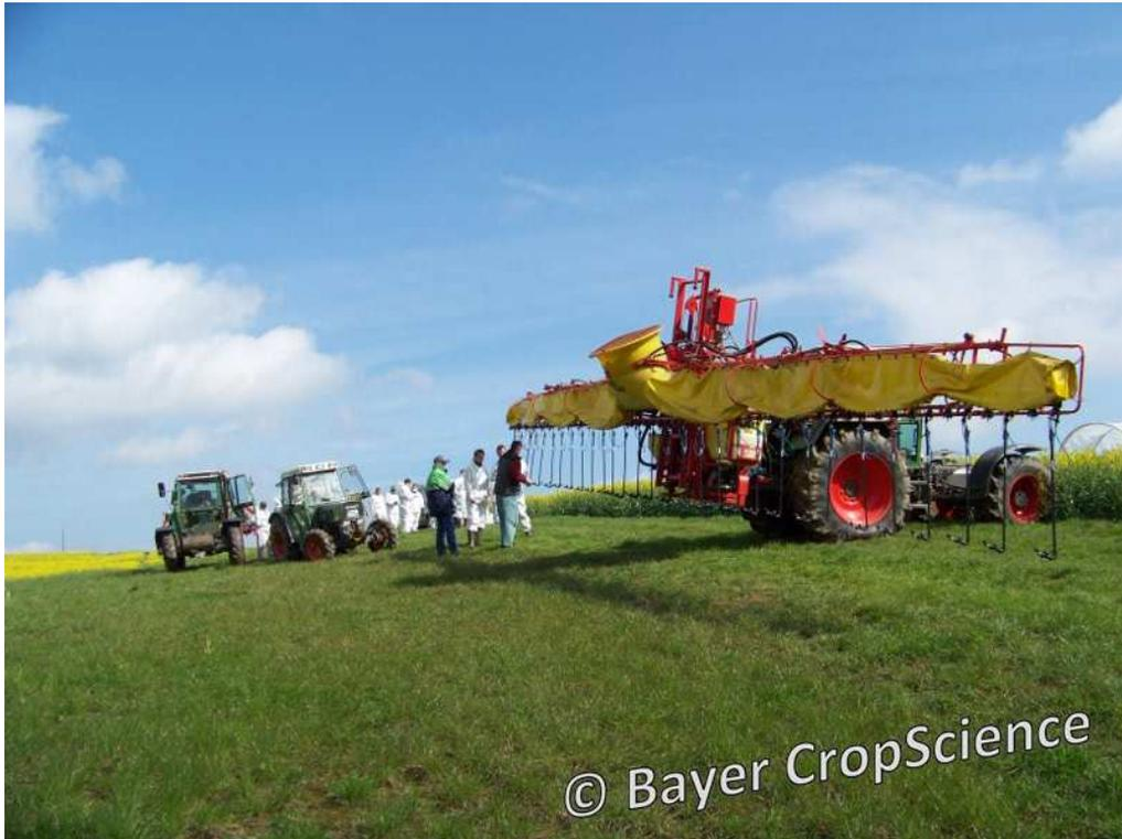
*Schlepper mit angebauter Feldspritze und den abgehängten Dropleg-Düsen*
