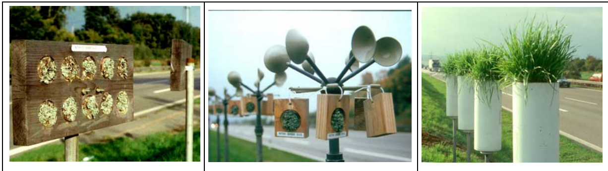
Abb. 2: An der Autobahn A 8 exponierte Flechten auf Flechtenbrettern (links) und auf Flechtenrädern (Mitte) sowie exponierte standardisierte Graskulturen (rechts).
